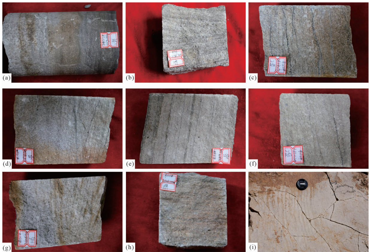
(a) 波状交错层理, 神 103 井, 2 490.9 m; (b) 底部板状交错层理、中部羽状交错层理, 米 9 井, 2 748.3 m; (c) 波状交错层理, 米 138 井, 2 814.9 m; (d) 羽状交错层理, 米 138 井, 2 818.1 m; (e) 板状交错层理, 米 138 井, 2 819.5 m; (f) 冲刷交错层理, 米 138 井, 2 820.1 m; (g) 羽状交错层理, 米 121 井, 2 658.9 m; (h) 冲刷交错层理, 米 125 井, 2 606.2 m; (i) 晋祠砂岩表面波痕, 吕梁招贤水
