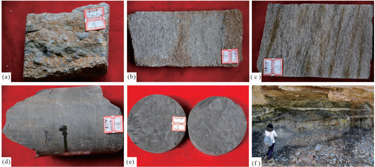
(a)砾岩,米 38 井,本 2 段,2 780.2 m;(b)含砾粗砂岩,神 103 井,本 1 段,2 484.6 m;(c)中—粗砂岩,含硫、含黄铁矿,神 51,本 1 段,2 330.2 m;(d)泥晶灰岩,米 119 井,本 1 段,3 026.0 m;(e)深灰色泥岩见碳化植物碎片化石,双 107 井,本 1 段,2 729.8 m;(f)的泥页岩及煤层,煤层中含硫和黄铁矿,兴县关家崖本 2 段
